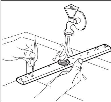
4. Drücken Sie zum Einsetzen des Sprüharms diesen nach oben und drehen Sie ihn gleichzeitig gegen den Uhrzeigersinn, bis er einrastet.
